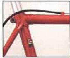
Inbusschrauben zur Sattelbefestigung
